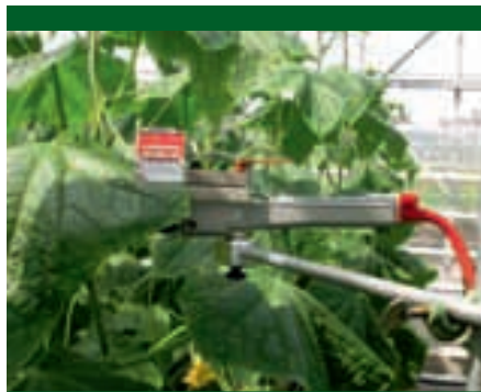
Meting van de fotosynthese van een komkommerblad.
