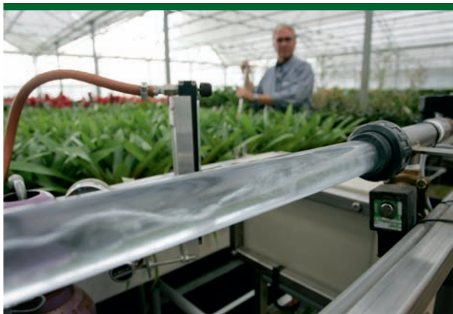
Met de nieuwe machine kan nu ter plekke, dus bij de planten zelf, ethyleengas met water worden gemengd.
