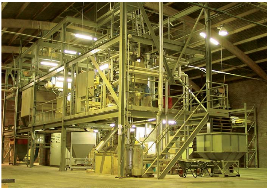
Nutreco beschikt sinds vorig jaar over een ingrediëntenonderzoekfaciliteit: een gespecialiseerd onderzoekslaboratorium met een kleine mengvoederfabriek.
