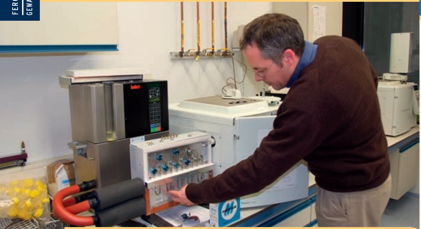
Frans Griepink bij een gaschromatograaf, waarmee hij feromonen kan ontdekken: "Het ideale systeem bestaat uit een combinatie van feromonen, natuurlijke vijanden en een goede hygiëne."
