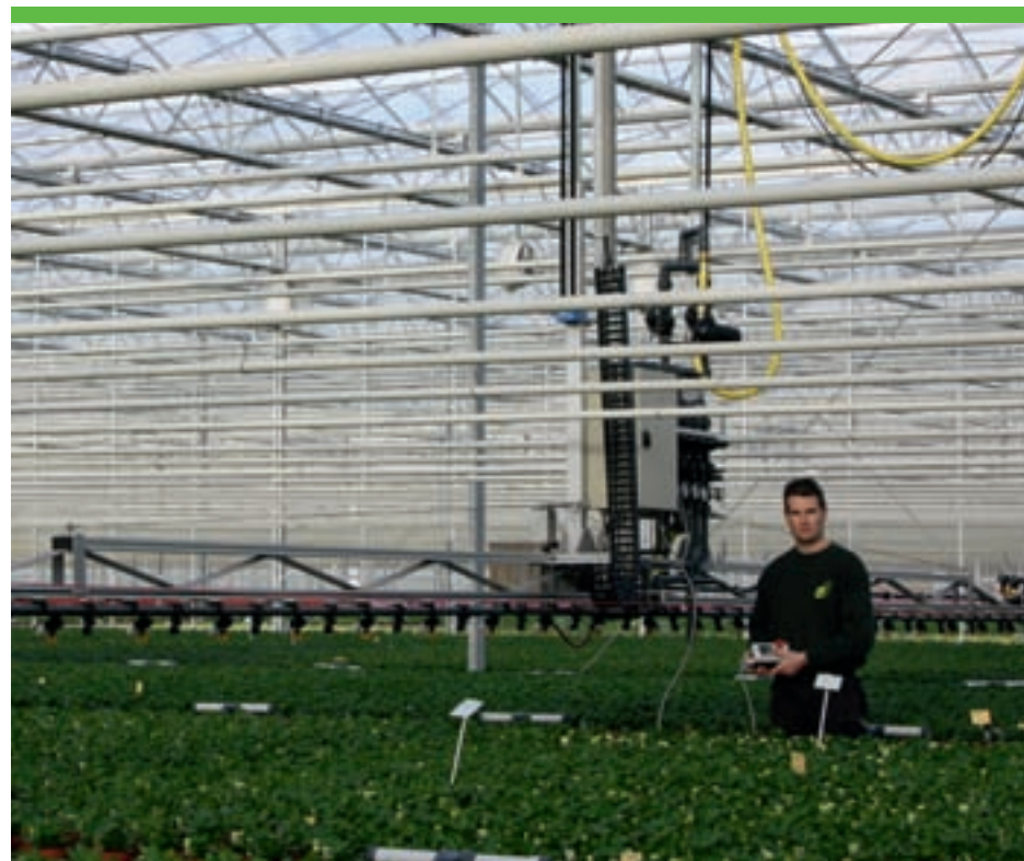
Chris Endhoven: "Deze spuitrobot heeft één leiding voor de remstoffen en één voor het watergeven. Bij aparte leidingen hoef je niet door te spoelen."
