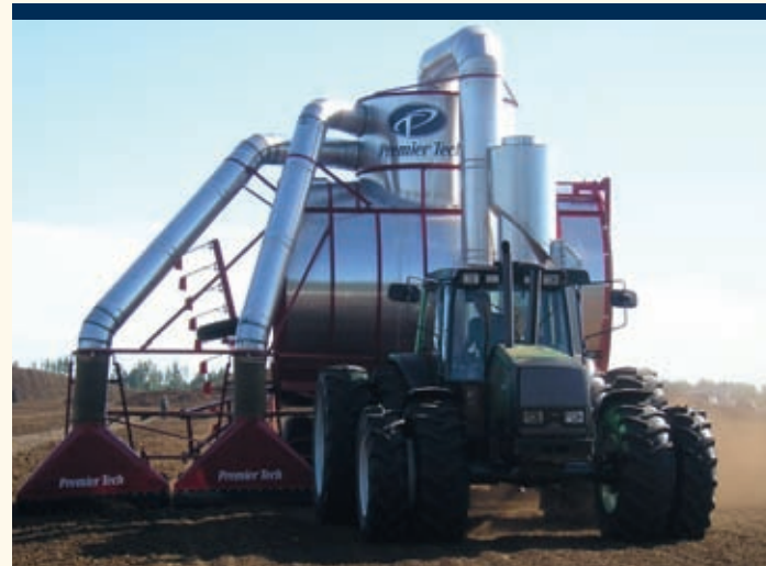
Na het losfrozen en drogen van de bovenlaag kan de vervener de droge 'freesturf' oogsten. Dit gebeurt meestal met verzamelmachines, die de turf op grote voorraadhoppen verzamelen.
