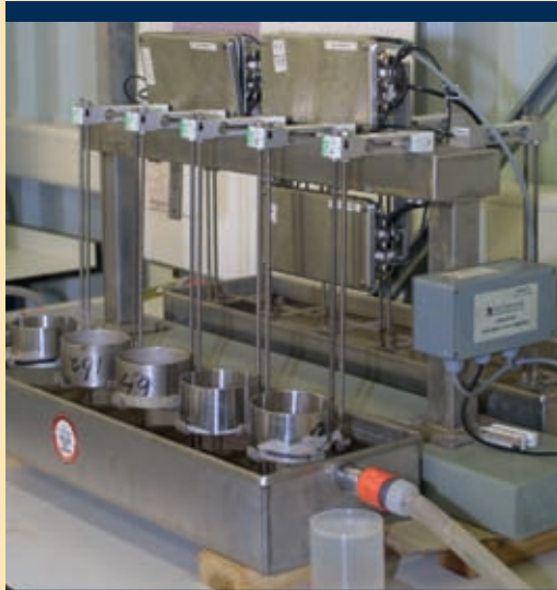
De meetopstelling voor WOK-analyse in het lab van RHP. De stalen monsterhouders zijn bevestigd aan weegunits.
