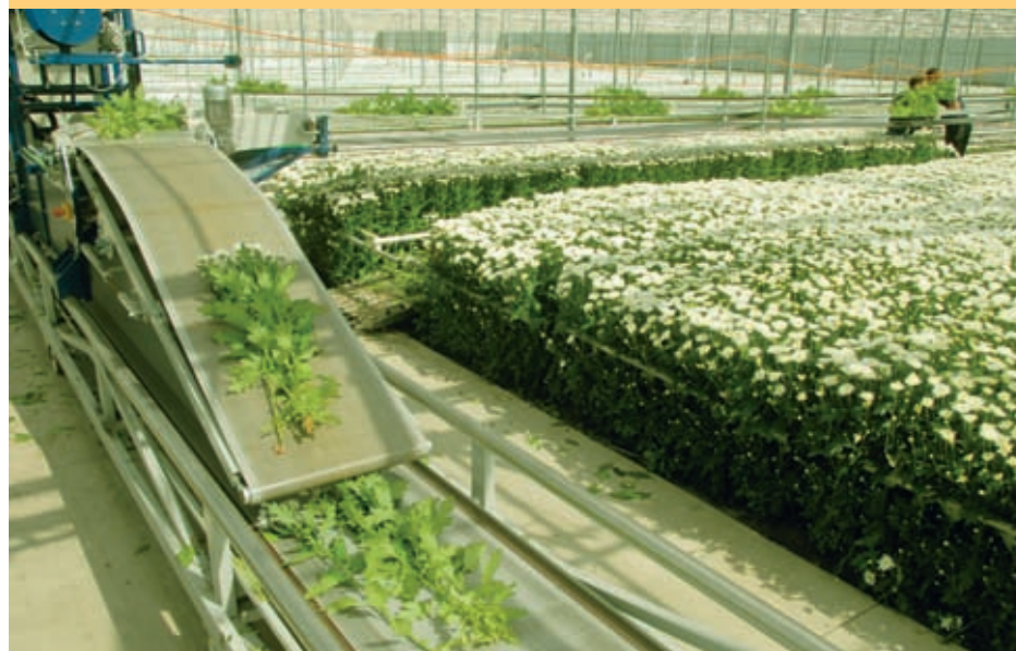
De nieuw ontwikkelde programmatuur legt de bossen van de tweede band keurig in de 'gaten' tussen de bossen van de eerste band op de hoofdband.
