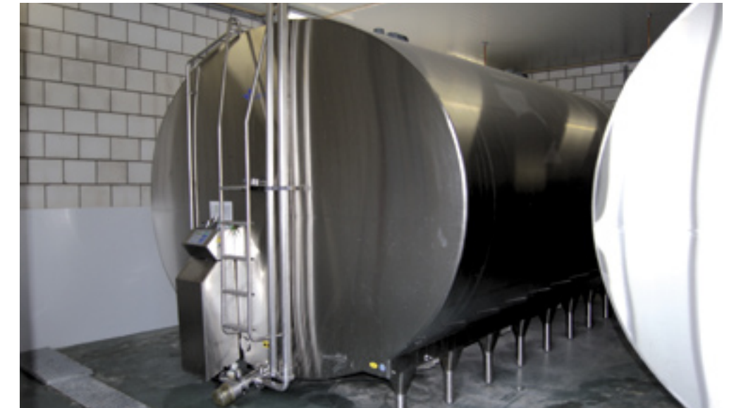
Een goede reiniging van de melkinstallatie inclusief melktank kan helpen het kiemgetal laag te houden.
