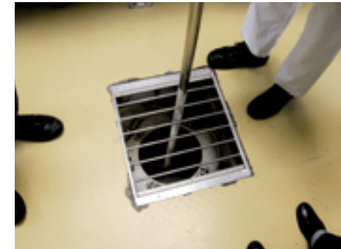
Met behulp van een lange buis wordt een monsters van een product genomen.
