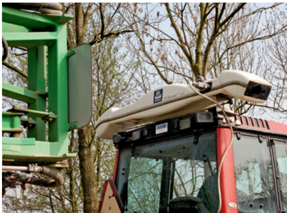
▲ Aan het uiteinde van de balk zitten een xenonlamp (links) en de sensoren voor de opname van het licht (rechts). De sensor bekijkt het gewas op 4,5 tot 7,5 meter uit de trekker.
