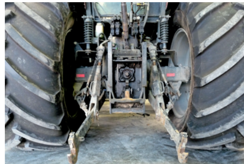
▲ De hefinrichting na gebruik sproeien is een goede gewoonte, maar vergeet dan niet regelmatig door te smeren. Vooral kunstmest is agressief. Opgelost in water kan het doordringen tot in nauwe passingen.
