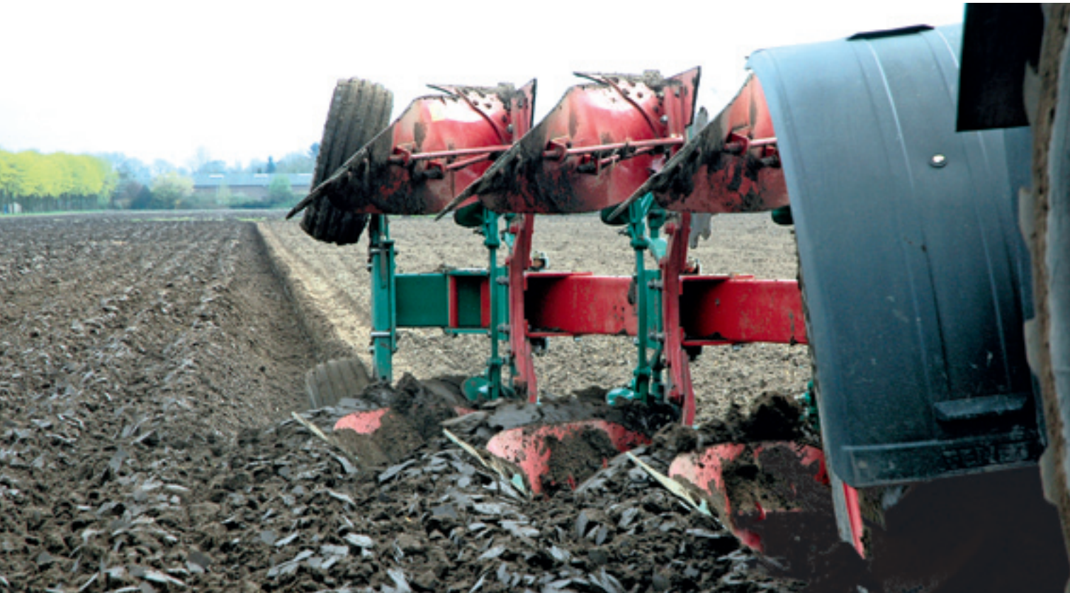
▲ De Fendt Vario 820 van Ad Buijs ploegt met een drieschaar wentel aan de neus en een vierschaar wentel achterop. De 200 pk trekker haalt op deze manier bij een snelheid rond 6,5 km/h op lichte grond een capaciteit van ongeveer 1,6 hectare per uur.
