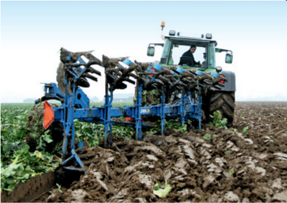
▲ De halfgedragen VariTansanit van Lemken gedraagt zich tijdens het werk als een gedragen ploeg. Deze 'hybride' hevelt zowel gewicht over naar de achteras als naar de vooras. De trekker krijgt daardoor zijn vermogen goed aan de grond.
