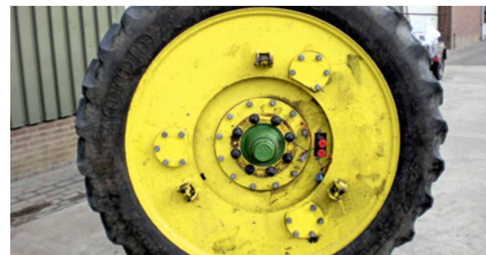
▲ Bij de velgen van Jilissen zaten er na een seizoen enkele scheurtjes in bij de bevestigingspunten. Deze zijn in de fabriek in België verstevigd.
