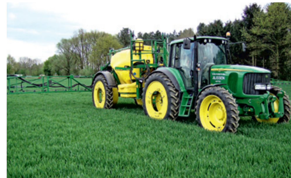
▲ Met de Hydrovarial kun je snel en eenvoudig wisselen van spoorbreedte. Het spaart bij Jilissen een trekker en spuit uit.
