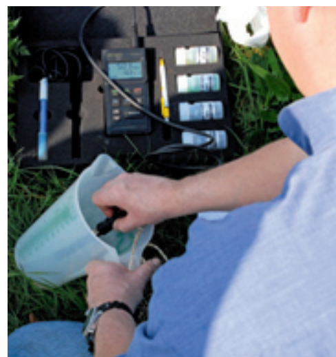
▲ DLV'er Richard Korver bepaalt de elektrische geleidbaarheid van het mengsel van schoon water en zout.
