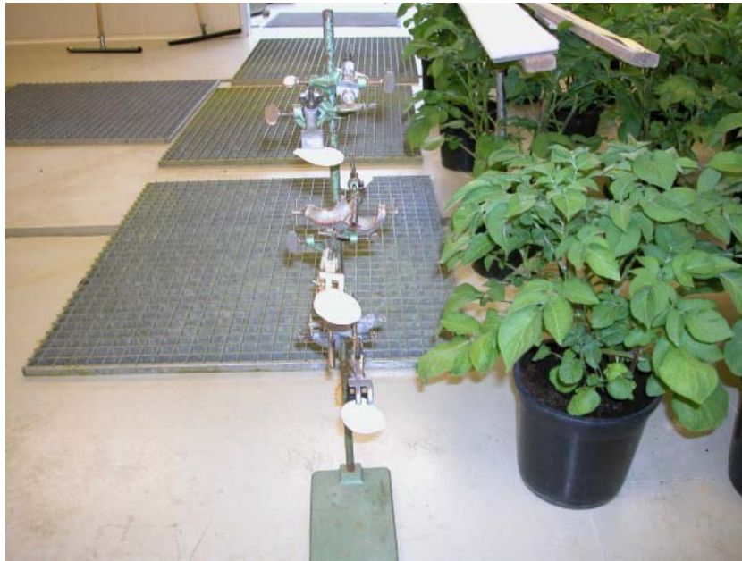
Figuur 5. Statief met rondfilters ter hoogte van de drie bladetages zoals geplaatst tussen de rijen naast de wisselplanten.
