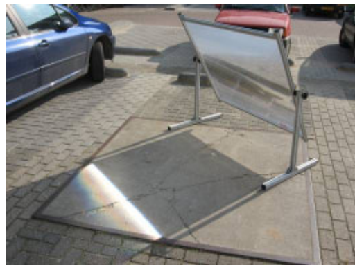
Figuur 2.2b. Foto met een lineaire Fresnellens PP.
