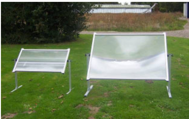
Figuur 2.2a. Foto met een lineaire Fresnellens JB (links) en een gewone Fresnellens JPK (rechts).
