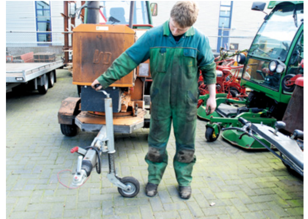
■ Een gemakkelijk te bedienen steunpoot is bij het aan- en afkoppelen van een aanhangwagen of getrokken machine een onmisbaar hulpmiddel.
