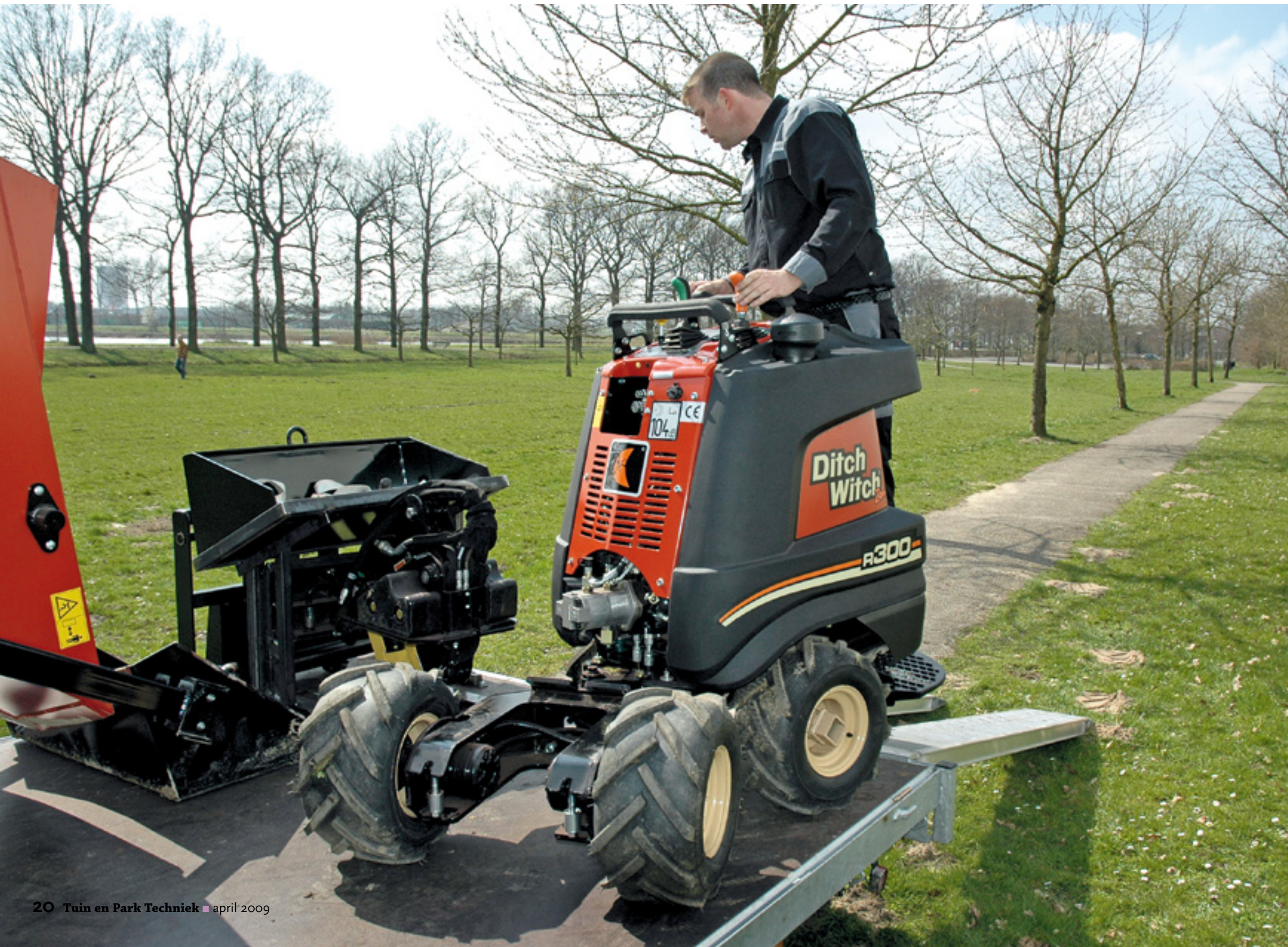
De Zahn is pas nieuw in het programma bij Ditch Witch en is ontworpen als basisvoertuig om een scala aan werktuigen eenvoudig aan te bouwen. Dat varieert van shovelarm tot grondboor, graafketting of zelf-ladende dumperbak.
