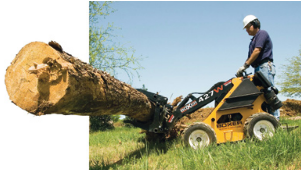
Werken met een mini schranklader is even wennen. Rijden gaat met twee hendels die ieder aan een kant de aandrijving van het wielstel of de rupsen regelen.
