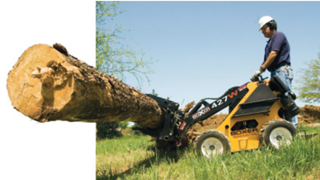
Werken met een mini schranklader is even wennen. Rijden gaat met twee hendels die ieder aan een kant de aandrijving van het wielstel of de rupsen regelen.
