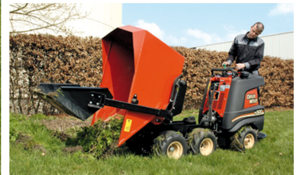
De Zahn is pas nieuw in het programma bij Ditch Witch en is ontworpen als basisvoertuig om een scala aan werktuigen eenvoudig aan te bouwen. Dat varieert van shovelarm tot grondboor, graafketting of zelf-ladende dumperbak.
