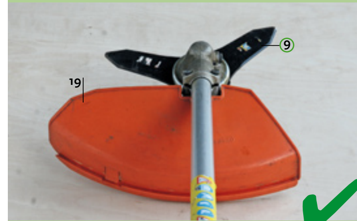
9: Stihl slagmes 300-3 De 'kale' combikap dient voor het werken met het slagmes. Bedenk wel dat alle kappen van de bosmaaier een zeer beperkte afscherming bieden. Oog- en gelaatsbescherming zijn altijd verplicht!
