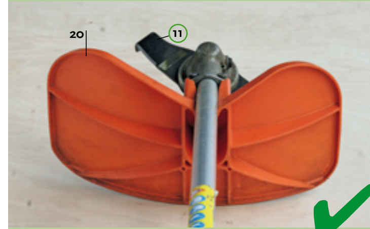
11: Stihl hakselmes 270-2 Dit gebogen mes werkt uitstekend, vooral bij halfgas, om bramen, opslag en kruiden kapot te hakselen. Het deelt enorme klappen uit waarbij de stukken ver weg vliegen. De grote versterkte kap is noodzakelijk om de werknemer te beschermen.
