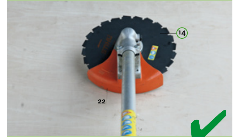
14: Stihl cirkelzaagblad 225 Bij een zaagblad zit het gevaar niet zozeer in het wegspatten van hout, maar in het wegslaan van de bosmaaier. Bij klemmen kan het zaagblad terugslaan (kick-back). De metalen aanslagkap geeft steun en controle over het zaagblad dat met 380 km/h ronddraait.
