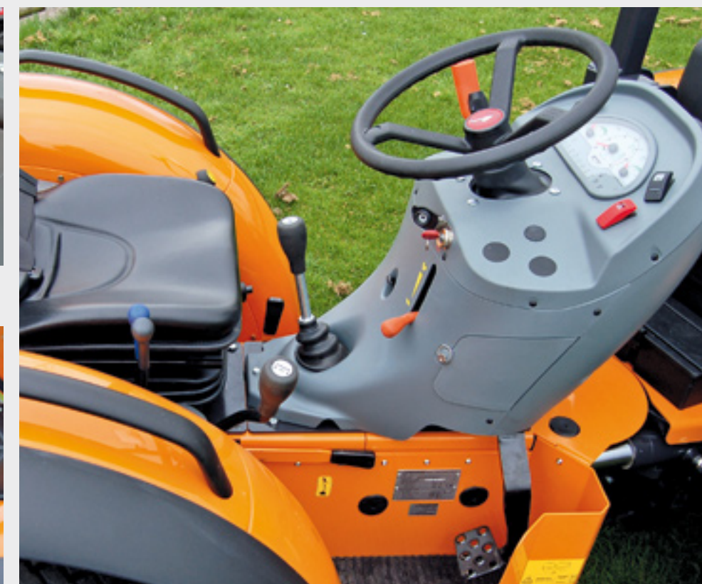
Er zijn 16 versnellingen: 4 versnellingen tussen de benen en een pook met drie groepen aan de rechterkant waarbij je de kruipgroep apart inschakelt met de hendel als de groepenpook in neutraal staat.
