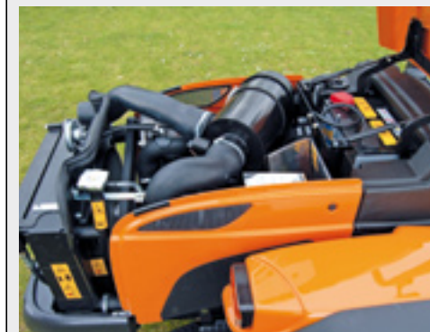
In de Valpadana 6575 ligt een John Deere viercilinder dieselmotor van 2.500 cc.
