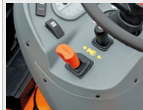
Met de powershuttle onder het stuur kun je tijdens het rijden van rijrichting veranderen.
