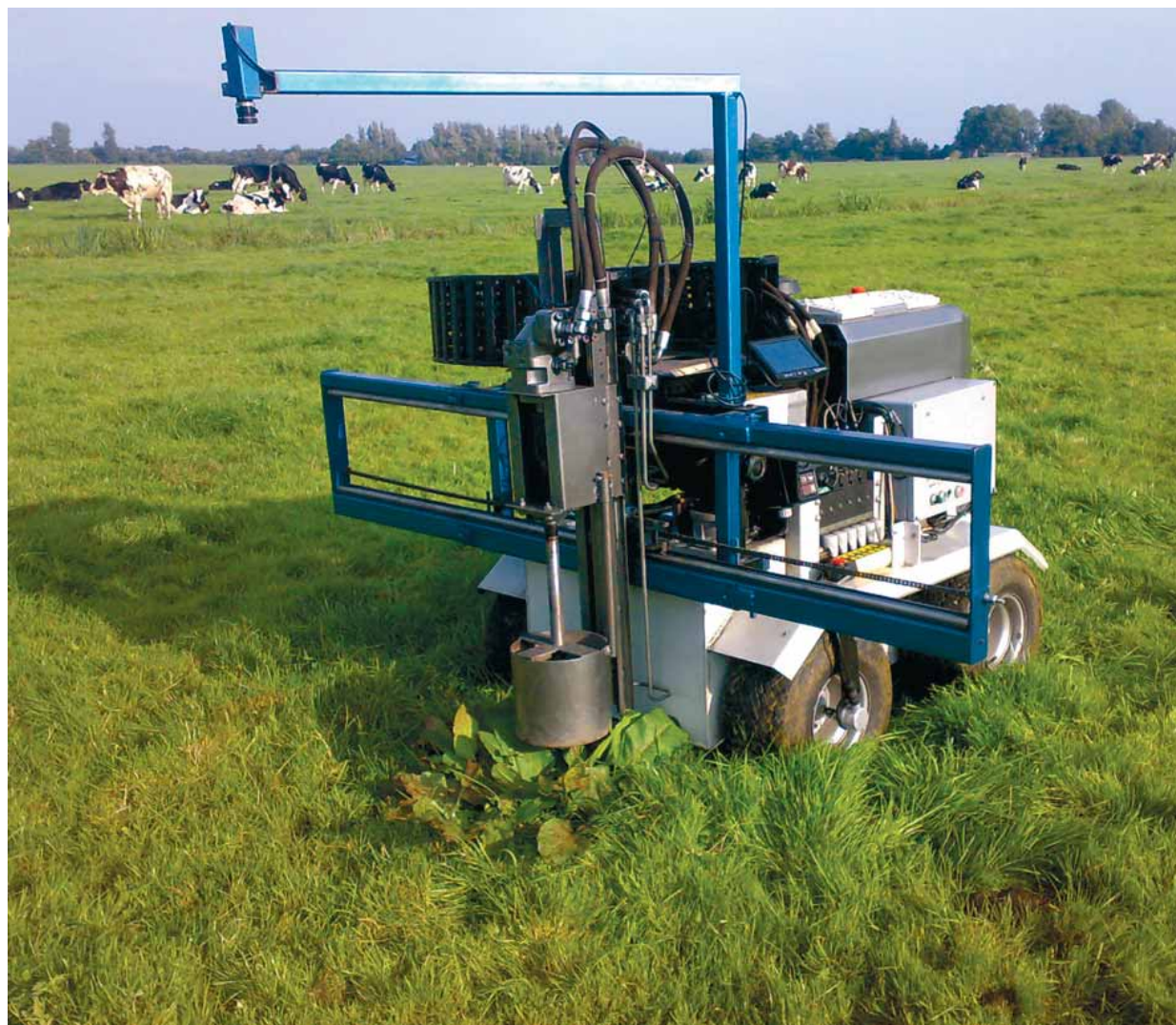
Robot Ruud heeft een beweegbare frees, waarmee hij tot op vijftien centimeter diepte de bodem verhakselt met plant en al. / foto Robert-Jan Samsom
