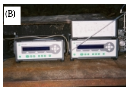
Figuur 6 Meetopstelling 2 voor emissiemetingen uit de mestopslag met vaste mest: verzamelleiding en fotoakoestisch monitor
