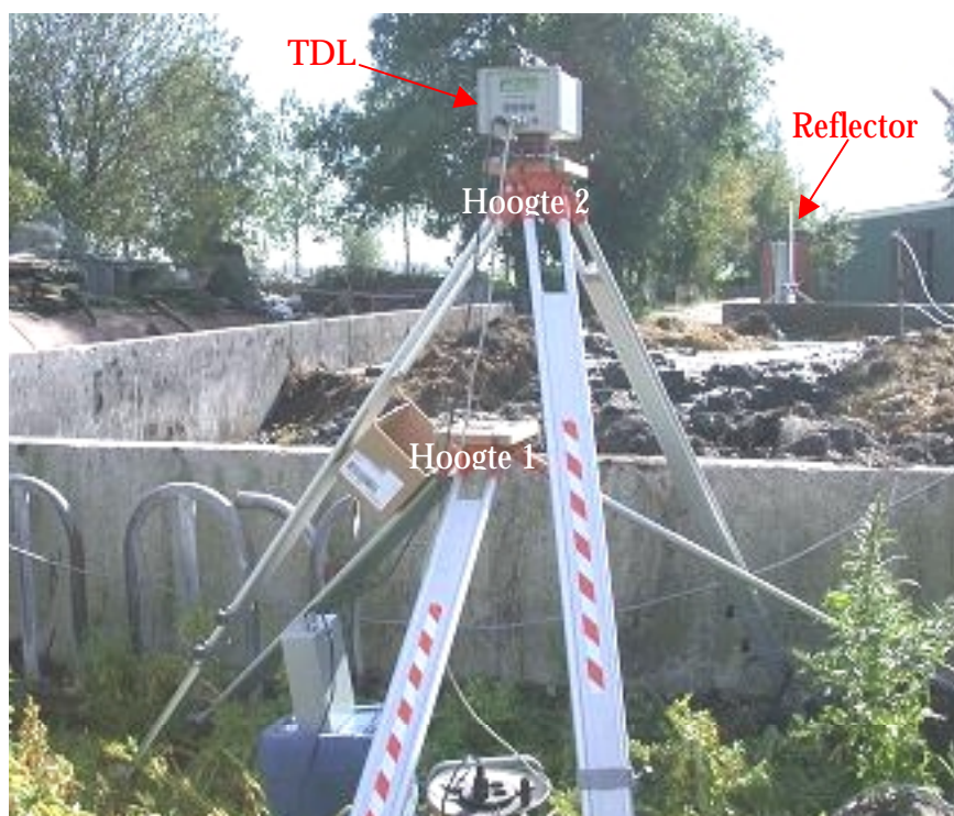
Figuur 5 Meetopstelling 1 voor emissiemetingen uit de mestopslag met vaste mest: open-pad tunable diode laser
