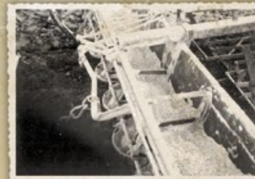
De voorraadbak van de schotelstrooier vraagt om versterking om de zware hoogliggende trekboom te kunnen verdragen.
