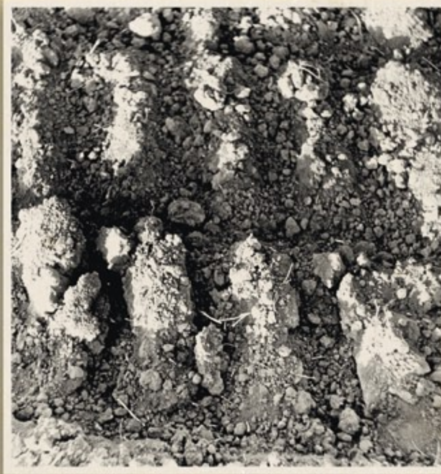
Het bijschrift bij deze foto van ir. Elema luidt: De verdichting van grond onder rupsbanden is vaak groter dan men verwacht, doordat de belasting bij een rupsrekker langer duurt.
