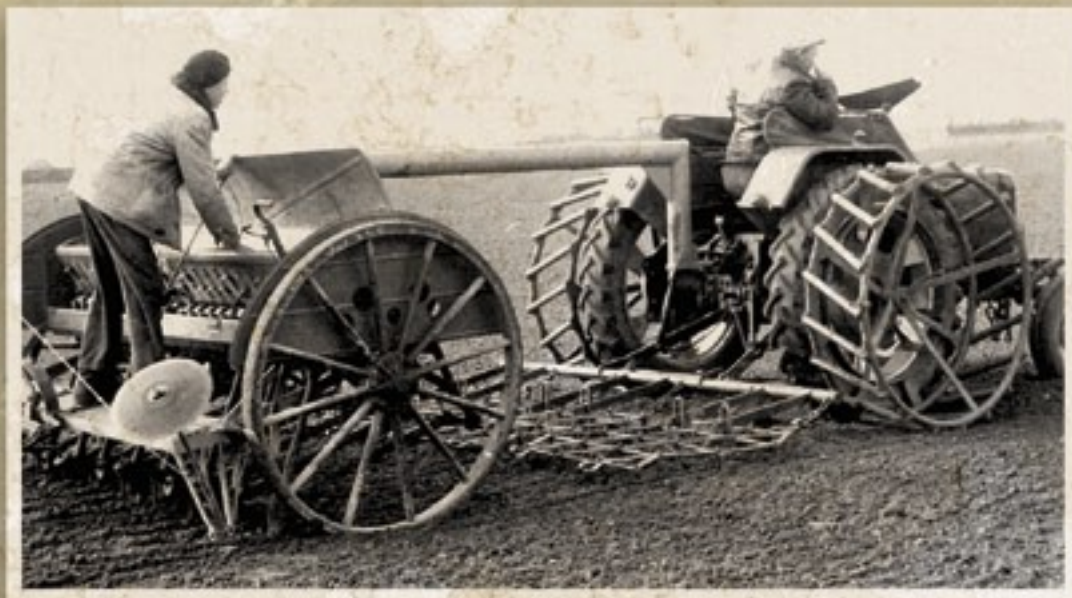
Kooiwielen zijn gangbaar om de bodemdruk te verlagen en de tractie te behouden.
