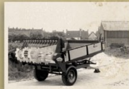
BAV in Oudenbosch is vooral bekend van kiepers, maar bouwt ook deze stalmeststrooier met het strooimechanisme van Amazone.
