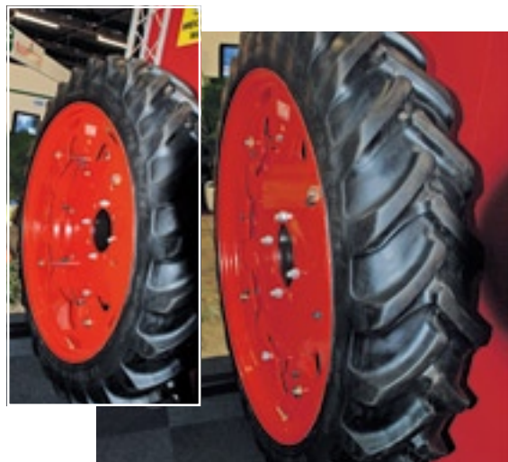
▲ WDM presenteerde een systeem waarmee je eenvoudig van spoorbreedte kunt wisselen. De pan kan over een geleide as schuiven en zo wisselen tussen spoorbreedtes van 1,50 meter en 1,80 meter. Voordat je de pan over de geleide as schuift, moet je het wiel ontlasten en draai je de velgmoeren tussen de pan en velg los. Dan schuif je de band om en komen de andere bouten door de pan naar buiten. Op die bouten draai je de velgmoeren weer vast en heb je een wiel hersteld.
