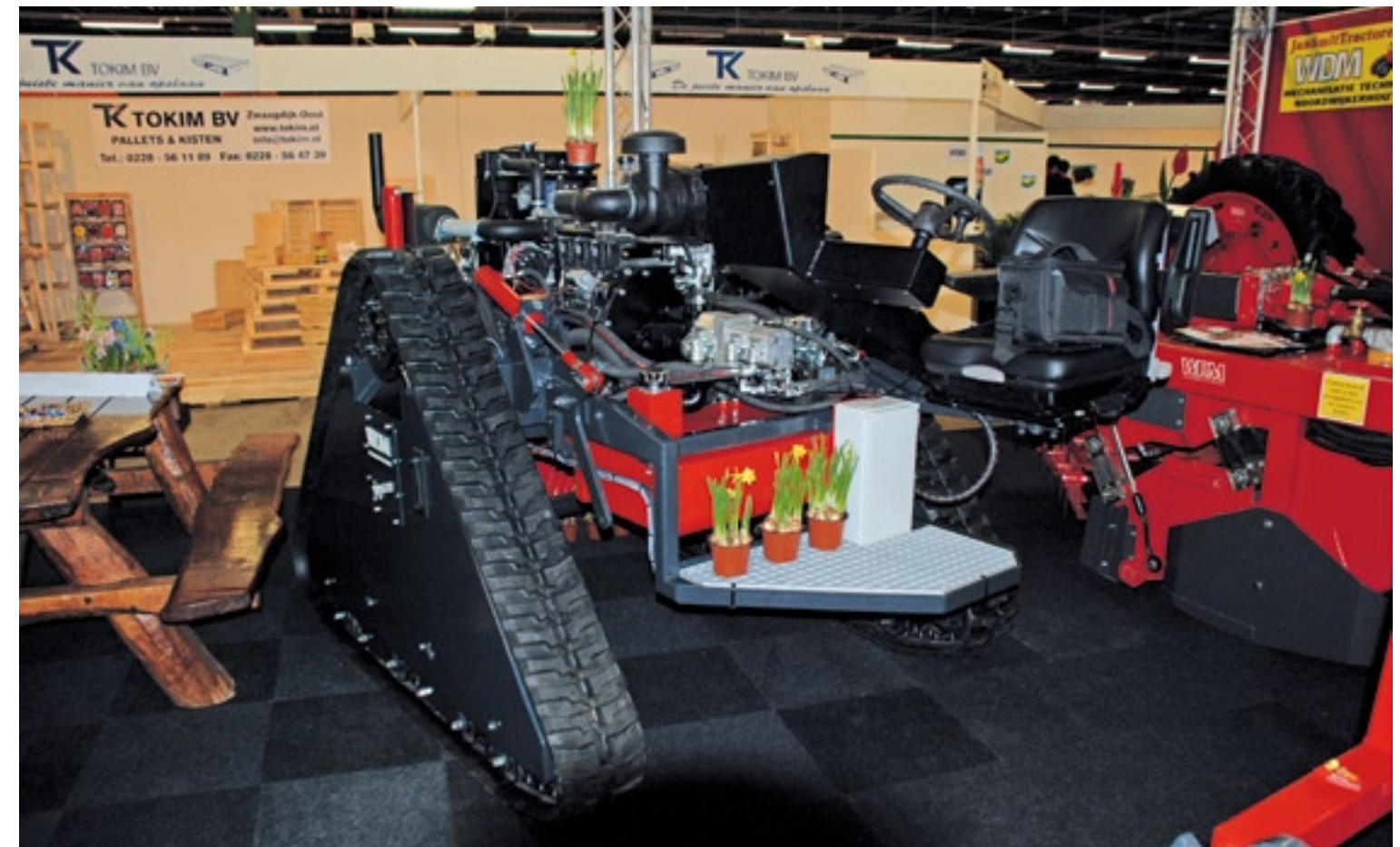
▲ WDM uit Noordwijkerhout ontwikkelt voor een klant een zelfaangedreven rupsrooier. De zelfgebouwde rooier heeft in elke rups een groot oliereservoir voor de aandrijving van een machine. Het zwaartepunt is gecentreerd waardoor het frame niet voor- of achterover kantelt bij het loskoppelen. Ontkoppelen van de rooier kun je doen om bijvoorbeeld een kopmachine aan te koppelen in de lente. De bestuurder zit boven de beitels, waardoor je in kleine ruimtes, zoals een kas, alles kunt rooien.
