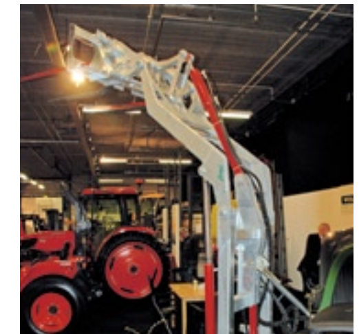
▲ Mechanisatiebedrijf Hoogervorst uit Noordwijkerhout is recentelijk importeur geworden van het Duitse Fliegl. Naast afschuifwagens bouwen het bedrijf ook eenvoudige voorladers. Die zijn te monteren in de fronthead en kunnen 1.500 kg tillen. Verschillende voorzetstukken zijn verkrijgbaar. Op de beurs stond een combinatie van een vorkenbord met prikkers. Met hetzelfde frame kun je dus zowel kisten als balen verzetten. De voorlader kost 2.650 euro, voor het functionele aanzetstuk betaal je 590 euro.
