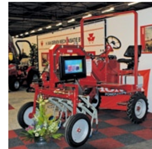
▲ Mechanisatiebedrijf van Gerven uit Lisse toonde zijn Gercon werktuigendrager. Gercon heeft diverse uitvoeringen. Op de beurs stond een versie met een schoffelbalk, maar een aangedreven wiedege, kappenspuif of maaibalk behoren ook tot de mogelijkheden. Het goede zicht op de machine en het gewas is mede te danken aan de hoog gepositioneerde zit. De hydrostatische aandrijving maakt het voor elke bewerking eenvoudig goed werk af te leveren.
