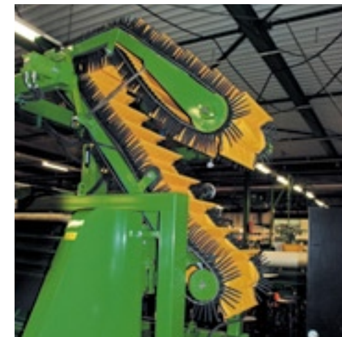
▲ Koops Machines en Techniek uit Middenmeer gebruikt bij zijn bollenrooiers tegenwoordig elevatorstechniek van de Duitse fabrikant Grimme. De afvoerband van 80 cm koopt René Koops bij Grimme omdat het volgens hem een productvriendelijk type band is en de fabrikant geruime tijd ervaring heeft met de afvoer van product. Bij bollen is het beperken van de valhoogte essentieel om beschadiging te voorkomen. De zijkanalen lopen mee, tussen de meenemers zitten geen spijlen, enkel het gele zeil.
