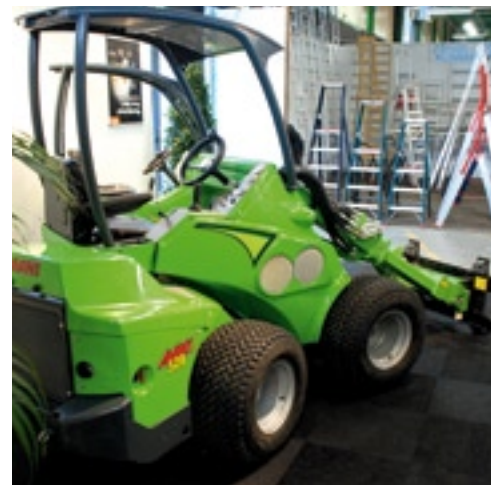
▲ Perfors levert in Noord- en Zuid-Holland deze Avant knikladers. Bij de machines zit je op het voorste gedeelte, maar achter het draaipunt. Dit zorgt ervoor dat de achterkant van de machine in een bocht altijd binnen de eigen cirkel draait. De telescooparm aan de voorzijde zorgt ervoor dat je veel meer kunt tillen doordat je het gewicht naar je toe kunt halen. De nieuwe 400-serie (600 kg tot 2,8 meter hoog) is een aanvulling op de grotere 500-serie (800 kg tot 2,8 meter).
