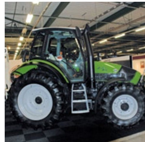
▲ Deutz-Fahr heeft met de M410 en M420 (105 en 116 kW) twee luxe viercilinders die een aanvulling op het programma tussen de K-serie en de grotere M6-serie opvult. De trekker is leverbaar met een 24/24 of 40/40 versnellingsbak en heeft standaard een viervoudige powershift. De commonrailmotor heeft een uitgasrecirculatiesysteem. Met gereduceerd toerental rijdt de Deutz 40 km/h, bij maximumtoerental 50 km/h.
