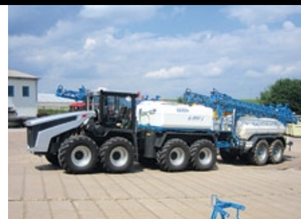
▲ Inuma paste een tank van 6.000 liter aan voor bevestiging op de XXL (hier in het zilvergrijs van DTU). Samen met de getrokken spuit zijn er zo lange dagen te maken. DF ziet de opbouw als belangrijk voordeel ten opzichte van de Trisix.
