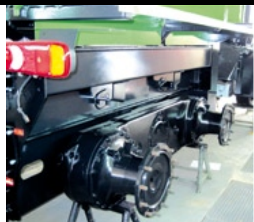
▲ De assen van de XXL zijn afkomstig van NAF. Vanuit het midden gaat de aandrijving via tandwielen naar elk van de beide naven. De verticale pendelweg van de 'boogie' is groot. Deze constructie past Volvo ook toe op zijn dumpers.
