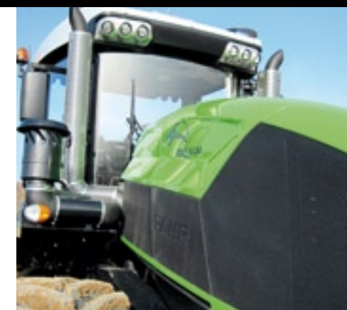
▲ De cabine was bij de T860 een project van de universiteit in Dresden. Op de XXL is het interieur onmiskenbaar Deutz-Fahr. Ondanks het vele glas wordt het zicht vlak voor de trekker sterk beperkt door de indrukwekkende motorkap.
