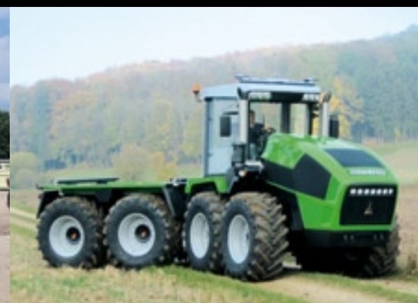
▲ De ophanging via boogjes geeft de wielen van de XXL een opvallend grote bewegingsvrijheid in het verticale vlak. Los daarvan kan het voorste deel van de XXL via het lengtescharnier torderen ten opzichte van het achterdeel.
