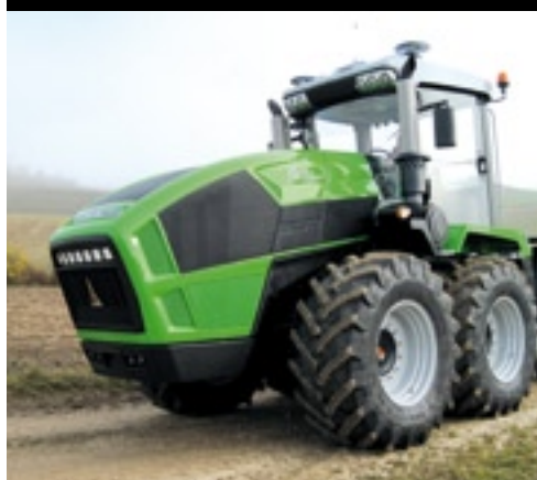
▲ De XXL maakt vooral indruk met zijn neus. Daarin huist de 15,9 liter V8 van Deutz met de type-aanduiding TCD 2015 V08. Deze turbodiesel met intercooler en elektronisch geregelde inspuiting genereert 440 kW/600 pk bij 1.900 toeren.
