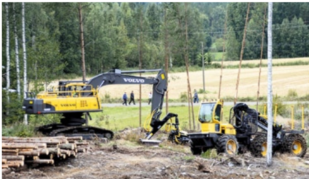
▲ De El-Forest heeft een diesel-elektrische aandrijving met wielmotoren. De tractie is via elektronica perfect over de zes wielen te verdelen, waardoor deze Volvo 'forwarder' frictieloos over de kwetsbare bodem rijdt.
