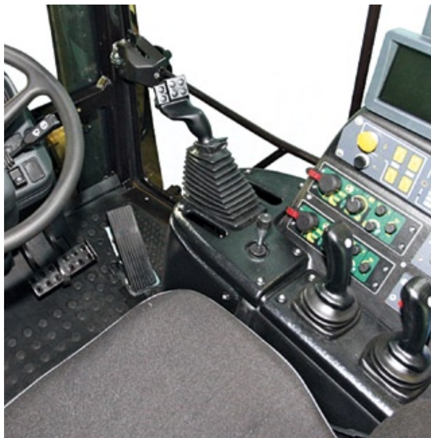
▲ Het interieur van de cabine van de Belarus 3023. Het kleine hendeltje rechts onder het stuurwiel bedient de voor-/achteruit. Via de monitor rechts kan de chauffeur de elektrische aandrijving controleren en beïnvloeden.
