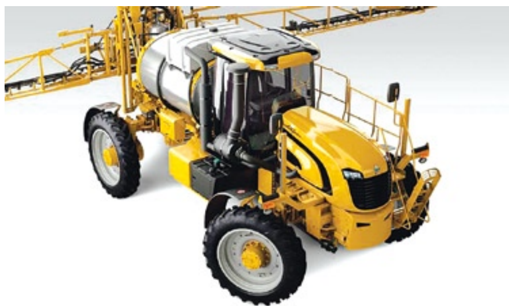
▲ De ElectRoGator heeft elektrische wielmotoren in plaats van hydraulische. Agco claimt ten opzichte van de gewone RoGator 1386 een 36 procent hoger weggrijpingskoppel, 35 procent meer trekkracht, 20 procent hogere brandstofefficiëntie en 70 procent minder hydrauliekolie.
