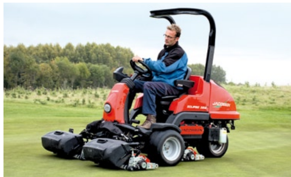
▲ De Jacobsen Eclipse 322 heeft als krachtbron een tweecilinder Kubota met een vermogen van 8,8 kW/12 pk. Deze diesel drijft op een laag toerental de generator aan die een accupakket op spanning houdt. De elektromotoren voor de wielen en voor de aandrijving van de maaikooien, putten uit deze accu's. Op hellend terrein of in een zwaar gewas verhoogt de motor zijn toerental. Jacobsen claimt ten opzichte van de normale diesel-hydrostatische uitvoering een brandstofbesparing tussen 35 en 45 procent.
