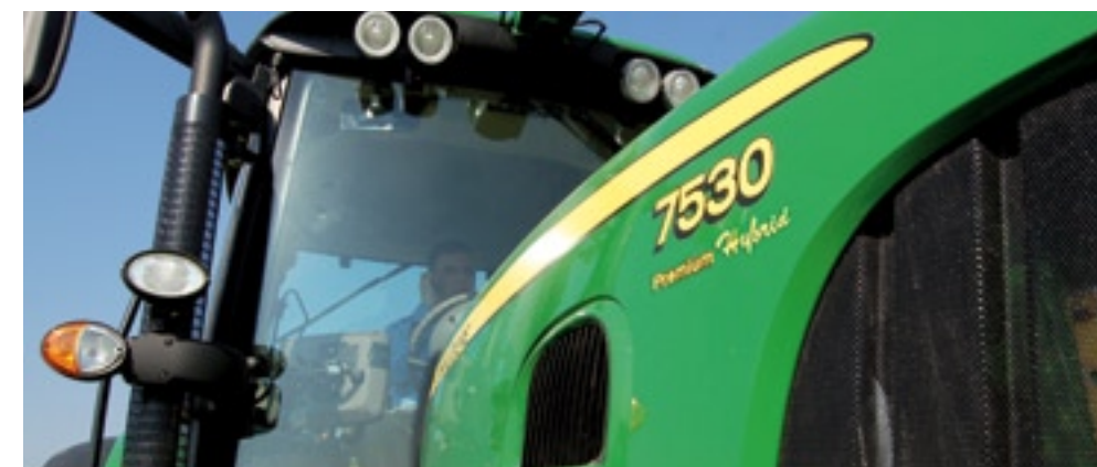
▲ De 7530 E van John Deere heeft een geïntegreerd elektrisch systeem voor nevenaggregaten en externe gebruikers. Deze hybride heeft op de korte termijn de beste toekomstkansen.
