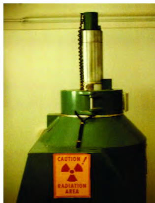
Figure 2. Cobalt-60 gamma source used for the irradiation of insects. Cobalt-60 gammabron die gebruikt wordt voor de bestraling van insecten.
