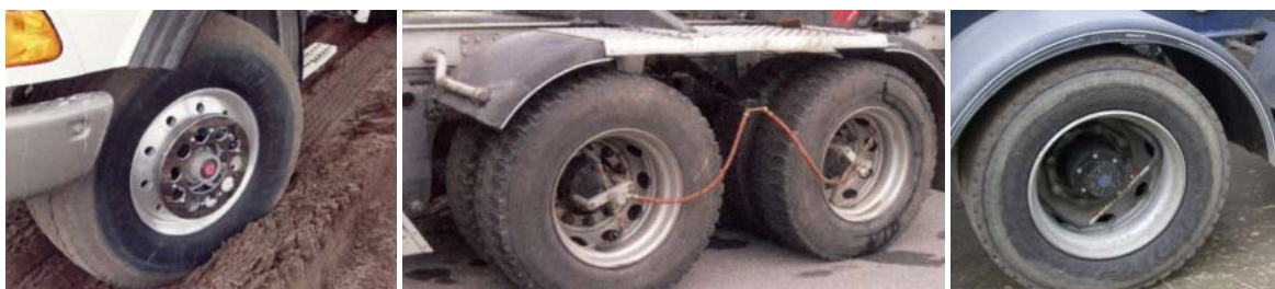
Figuur 5. Luchtleiding geïntegreerd in de as (links, stuuras), buitenom lopend (midden, aangedreven assen) en door de as met roterende luchtkamer op de as (rechts, traileras) (Bron: TPC International).
