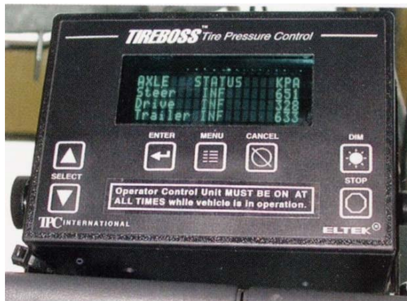
Figuur 3. Regelunit voor menugestuurd instellen van de bandspanning van de stuuraswielen, de aandrijfswielen en de trailerwielen (Bron: TPC International).
