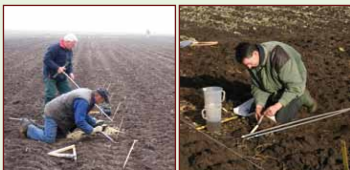
Installeren van macrorhizons voor het afzuigen van bodemvocht op 30, 60, 90, 120, 150, 180 en 210 cm diepte.
