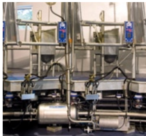
De melkontvangst onder de rotor is van rvs. Dit is onderhoudsarm en eenvoudig te reinigen.
