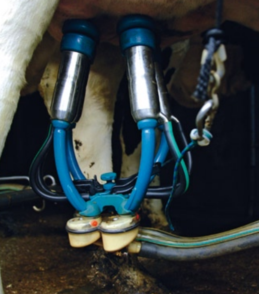
De korte vacuümslangen aan de binnenkant van het melkstel maken het stel slanker, waardoor de koeien het melkstel moeilijker aftrappen.
