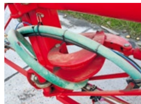
▲ Door twee halve manen kun je met korte cilinders de spuit open- en dichtvouwen.
