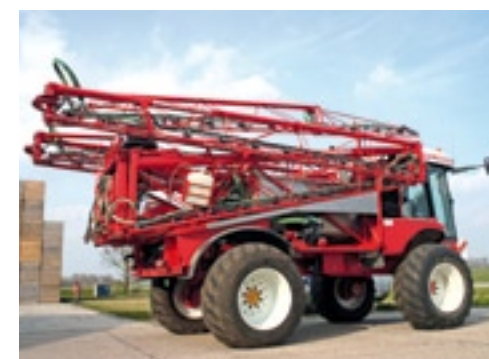
▲ Na het dichtvouwen daalt het middenstuk zover, dat de maximale hoogte 4 meter is.
