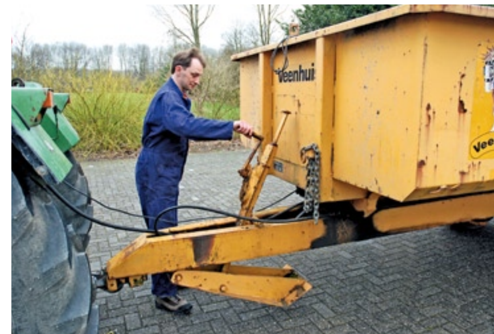
▲ Een gemakkelijk te bedienen steunpoot is bij het aan- en afkoppelen van een wagen een onmisbaar hulpmiddel.
