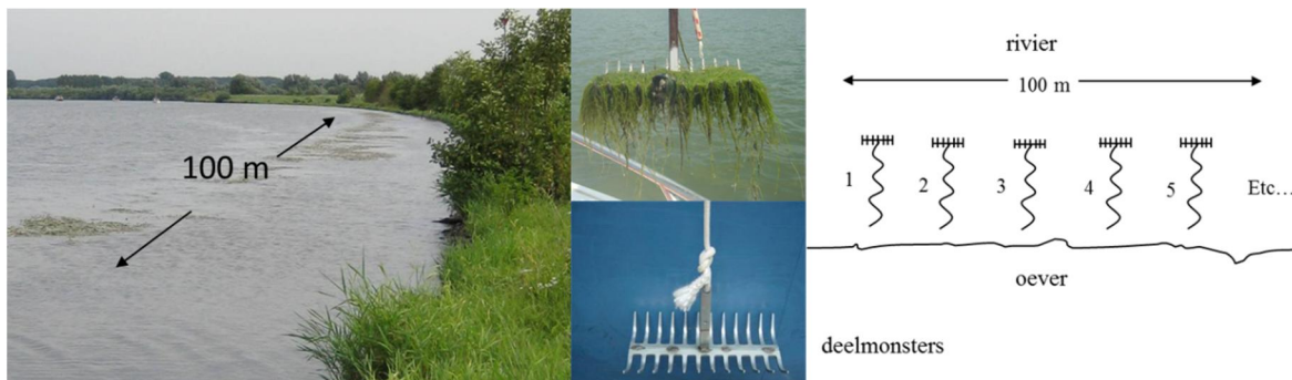
Figuur 2.2 Methode voor waterplanten bemonstering met werkhark
