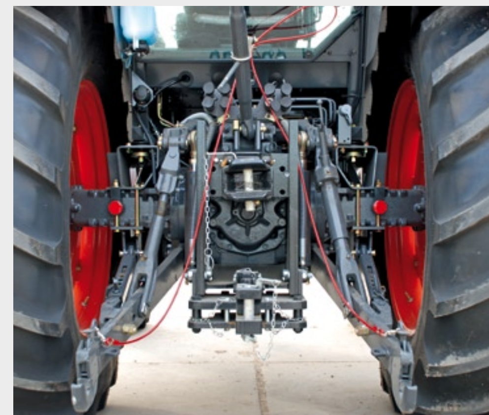
▲ De achterkant van het gelijk biedt bij Kubota voldoende hefkracht, een praktische stabilisatie en ruimschoots hydraulisch vermogen. De aftakas heeft 540 en 1.000, maar mist spaarstanden.
