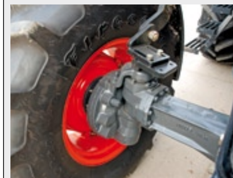
▲ Bi-Speed geeft een prima wendbaarheid door de voorwielen extra te versnellen.
