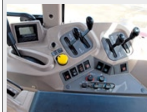
▲ Standaard heeft de M128 twee dubbelwerkende ventielen. Onze versie had er als optie twee extra. De snelheid verschijnt in het displaytje.
