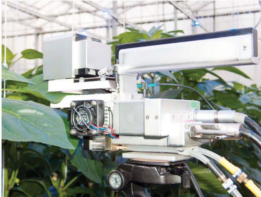
Figuur 3.1. LiCor-6400 meetapparatuur. Assimilatieparameters en fluorescentie (ETR) werden gemeten met de LiCor 6400. In de meet cuvette van deze apparatuur aan boven- en onderzijde van het ingeklemde blad) worden lichtintensiteit, CO 2 concentratie, temperatuur en de relatieve luchtvochtigheid door een computerprogramma ingesteld en gevarieerd. Hierdoor kan de reactie van de assimilatie op deze veranderingen bepaald worden
