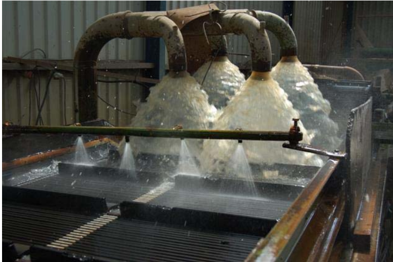
Spoelinstallatie waarbij met een beperkt volume wordt nagespoeld (de vier kleine sproeikoppen). Foto: Arie Dwarswaard Bloembollenvisie
