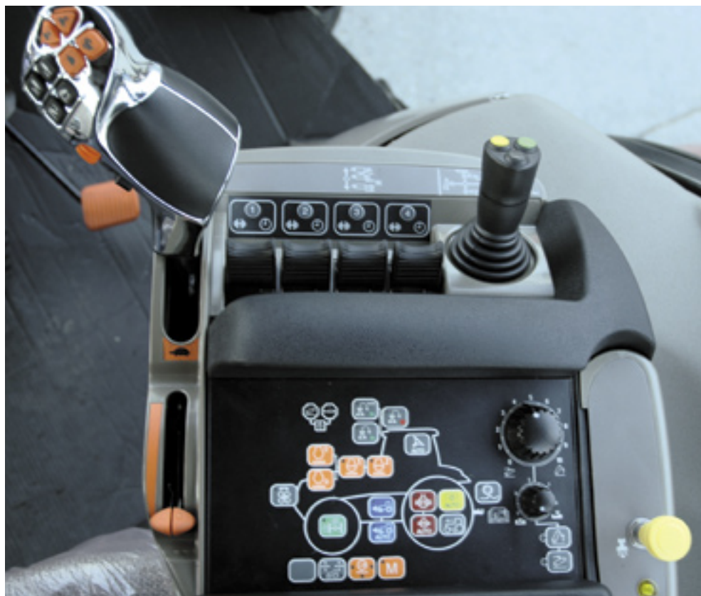
▲ De armleuning met linksboven de nieuwe 'multicontroller' die nu ook rijhendel is. Rechtsboven zit de joystick voor de hydrauliek.
