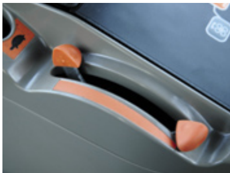
▲ Twee gashendels stemmen het gewenste toerental af op de maximale spreiding.
