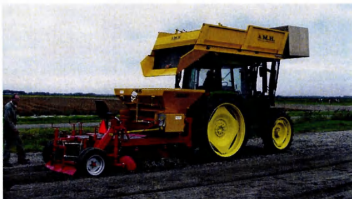
Figuur 3.2: Regelplanter/sloffenplanter achter een trekker met plantdak gemonteerd.
