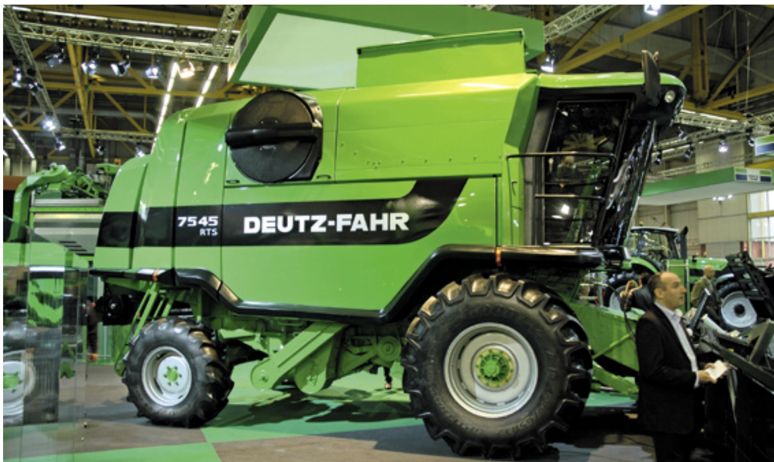
▲ Deutz-Fahr betreedt met het nieuwe type 7545 RTS de markt van de axiaalmaaidsers. De rotor ligt daarbij in de lengte van de machine en heeft een lengte van 3.150 mm en een doorsnede van 750 mm. De aandrijving is hydraulisch, waardoor de draaisnelheid makkelijk is aan te passen aan de omstandigheden; ook kan hij bij een verstopping eventueel andersom draaien. De motor is een V6 van Deutz met een vermogen van 336 kW (450 pk). De graantank van 9.000 liter lost met een snelheid van maximaal 90 l/sec.
