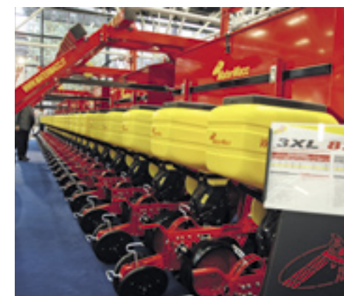
▲ De MaterMacc 3XL 824-S was op de Eima onder de zaaimachines qua grootte veruit de kampioen. Deze enorme pneumatische precisie-zaaimachine heeft 24 elementen op een onderlinge afstand van 70 of 75 cm en wordt in de lengte getransporteerd. Het feit dat de brochure van de 3XL behalve in het Italiaans, Duits en Frans ook in het Russisch gesteld is, geeft aan in welke richting MaterMacc qua afzetgebied denkt.
