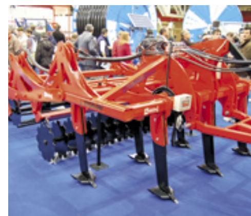
▲ Ook de cultivator van Angeloni kreeg een innovatie-onderscheiding. Speciaal aan de machine zijn de diverse eenvoudige verstelmogelijkheden, volgens de jury. De machine bestaat uit zeven tanden die variabel tot 40 cm diep kunnen werken. Daarachter zit een rij gekartelde schijven op een frame die je ook hydraulisch kunt verstellen. Hierachter zit weer een kooirol die de grond zaaiklaar legt. Ook deze is hydraulisch verstelbaar. Op de machine zitten ultrasound dieptesensors en krachtsensors. Hiermee kan de machine ook informatie opslaan en bodemkaarten maken voor andere gps-toepassingen.
