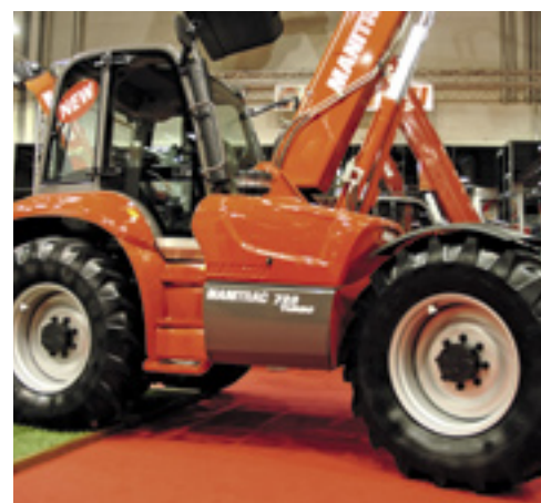
▲ De ManiTrac van Manitou is een kruising tussen een telescoopklader en een trekker, met een motorvermogen van 106 kW (144 pk) en een hydrostatische transmissie. De arm komt tot een maximale hoogte van 6,8 meter, zeg maar 7 meter, en tilt maximaal 2,8 ton. Dat is in de typeaanduiding terug te vinden. De 728 staat op rubber in de maat 19.5LR28, vierwielbesturing is standaard en de top ligt op 38 km/h. De achterzijde van de ManiTrac is voorzien van een mechanische aftakas met 540/1000 en een hef-inrichting. De hydrauliek heeft een opbrengst van 140 l/min.
