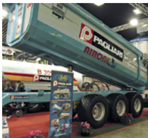
▲ Italië is, samen met Frankrijk, het land van de grote kippers. Pagliari doet op dat front een forse duit in het zakje met zijn topmodel de SC 820. De bak is 8 meter lang, 2,30 meter breed en 1,70 meter hoog. Samen met een lichte kop geeft dat een inhoud van 32 kub. Hydraulische besturing op de voorste en de achterste as van het mechanisch geveerde onderstel is standaard, evenals bladvering. Luchtvering is een optie en de typeaanduiding van de SC 820 krijgt in dat geval de toevoeging 'airone' mee.
