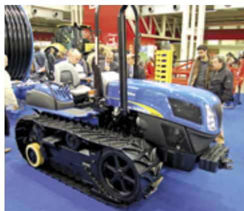
▲ New Holland introduceerde een nieuwe rups op de TK-serie. De stalen rups zou minder geluid en trillingen hebben. Dit moet komen door trekwielen die met rubber omzoomd zijn, een polyurethaan wiel naast de getande aandrijfwielen en twee rubberen rollers. Oftewel, het rubber voorkomt staal-staalcontact wat dus geluid en trillingen reduceert. De rups heeft een visgraatprofiel wat voor voldoende grip op de grond moet zorgen. De TK-rupstrekker is er van 74 tot 94 pk en met een hefvermogen tot maximaal 3.720 kg. De eerste TK4020 met zo'n 65 pk kost circa 45.000 euro en is al aan een Nederlandse bollenboer verkocht.
