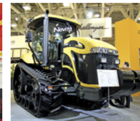
▲ Stond er in de typeaanduiding bij de Challenger rupstrekker een B, op de stand pronkte nu een MT 765 C. Dit is een vernieuwde versie van de rupstrekker. De nieuwe C-serie, de MT700/800 C met vermogens van 206 tot 446 kW (277 tot 600 pk), heeft onder andere meer hydraulisch vermogen. Vanbinnen zit een nieuwe isobus-terminal met kleurenscherm die je ook voor gps- en camerafuncties kunt gebruiken. Als optie kun je een aangepaste rups krijgen die iets minder geluid en trillingen zou maken. Deze heeft polyurethaan-rupsgeleidewielen in plaats van de rubberen.
