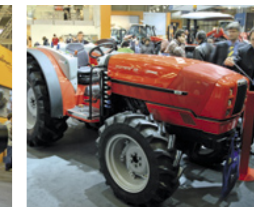
▲ Same stelde samen met het zustermerk Deutz-Fahr de traploze transmissie voor in de populaire vermogensklasse rond de 100 pk. De Frutteto 110 krijgt voor die cvt-techniek de toevoeging 'continu' mee. Bij Deutz-Fahr heet diezelfde techniek, maar dan met een ander uiterlijk en uiteraard in het groen, Agrofarm TTV 4.30. De levering van de trekkers komt niet eerder dan de tweede helft van 2009 op gang.
