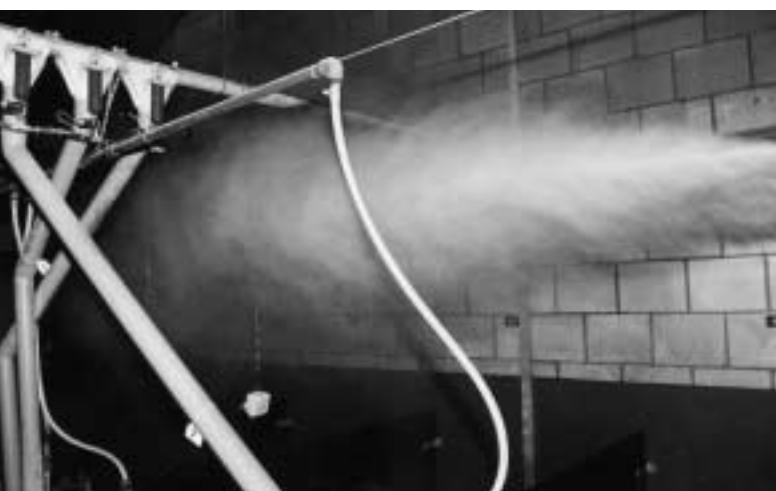
Verneveling van een olie-emulsie; een methode om het stofgehalte in stallen te verlagen
