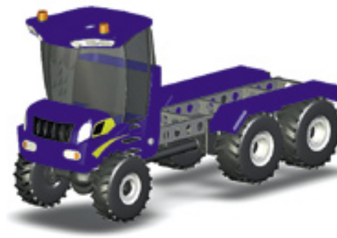
▲ Veldhuizen Wagenbouw presenteert ruim drie jaar na de introductie van de Hovertrack een nieuwe versie. Deze Hovertrack is voorzien van een New Holland ruimzichtcabine op een chassis van Iveco. Het voertuig is geschikt voor een snelheid tot 80 km/h en mag maximaal 30,5 ton wegen. Hiervoor heeft hij een mechanisch stuursysteem en ABS en vering op alle wielen. Het terreingewicht is echter maximaal 50 ton in combinatie met een volgaanhangwagen of oplegger. De Hovertrack is standaard voorzien van 445/65R22.5 voorbanden en 600/70R20.5 achterbanden. 710/50R26.5 achterbanden is een optie.
