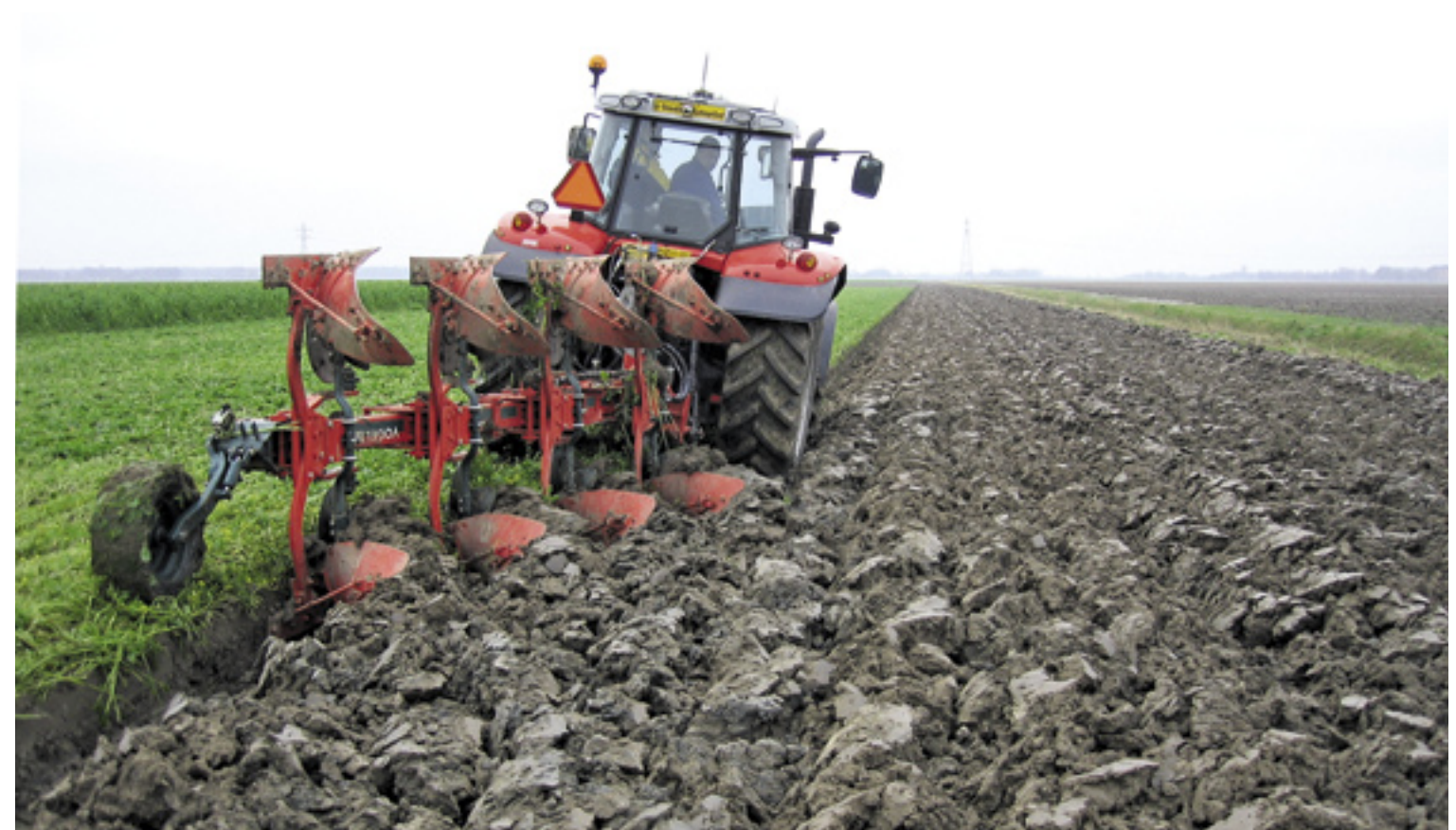
▲ Geometius uit Alphen aan de Rijn, importeur van Trimble gps-producten, heeft een nieuw systeem voor het aansturen van een varioploeg met rtk-gps. Het systeem heet Geoplough en stuurt de ploeg hydraulisch in de juiste richting om de A-B lijn van het gps-systeem te volgen. Hierdoor blijft de ploegvoor recht of evenwijdig aan de lijn van het gps-systeem. Het systeem is tot op 2 cm nauwkeurig. Het Geoplough-systeem is ook aan te sluiten op elektrisch bediende ploegen.
