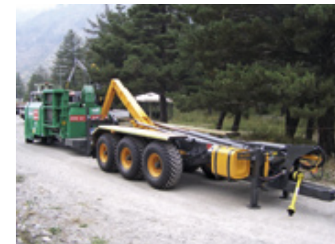
▲ Slecoma introduceert de Roagna Agrilift carrier met weegstelsel. Het is een container haakstelsel met een hefcapaciteit van 26 ton, met een hydraulisch geveerde dissels en assen. De rvs weegcellen zijn op vier plaatsen volledig in het frame geplaatst, zodat de kans op beschadiging kleiner is. Tijdens het wegen tilt een hydraulische cilinder de container of opbouw vrij van het frame. De weeginrichting is standaard voorzien van een printer. IJken van het weegstelsel is mogelijk.
