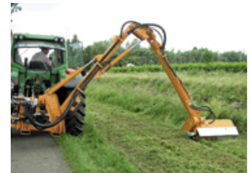
▲ Machinefabrikant Votex presenteert de nieuwe Clipper 60 en 70. De armklepelmaaier hebben een groter bereik dan de Clipper 50 en meer hydraulisch vermogen. De Clipper 60 en 70 hebben, net als de kleinere types uit de serie, een eigen hydraulisch systeem en werken daarmee onafhankelijk van de trekkerhydrauliek. De botsbeveiliging is hydraulisch en gekoppeld aan de eerste arm. De klepelbak wijkt bij een botsing met een obstakel naar achteren uit en wordt automatisch opgetild. De machines zijn standaard uitgerust met bowdenkabelbediening. Een elektrische of elektrisch-proportionele bediening met een joystick zijn een optie.
