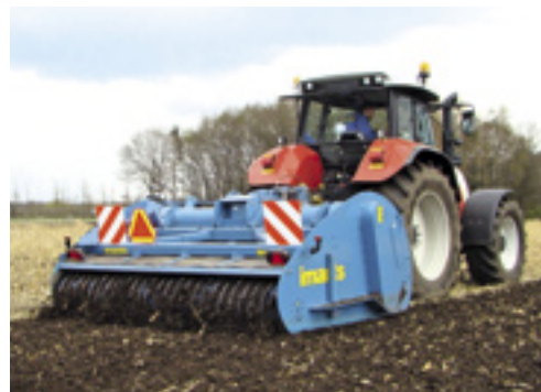
▲ Na de introductie van de Revolution 37 en 47 snelspitters van Imants is het nu de beurt aan de Revolution 57. Deze nieuwe spitmachine is geschikt voor trekkers vanaf 175 kW (200 pk). De werksnelheid van deze machine is 9 km/h. Dit zorgt voor een capaciteit van ongeveer 2,5 hectare per uur. De machine is voorzien van verwisselbare spitbladen.
