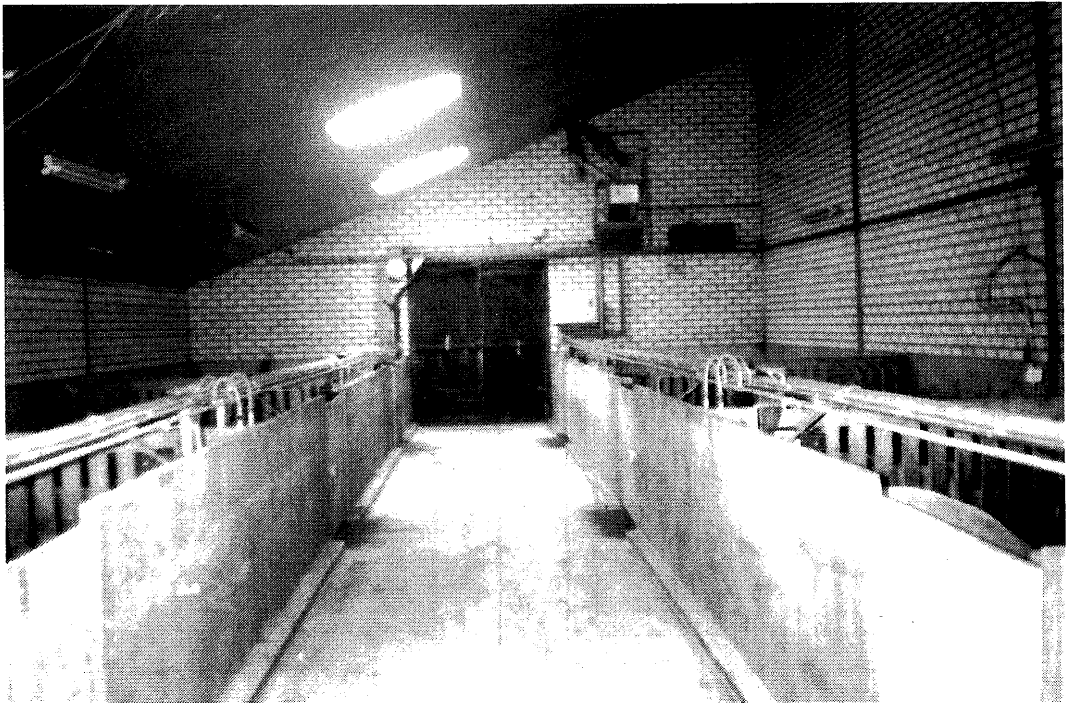
Foto 1: Het brede voerpad maakt het mogelijk dat het zaagselbed met een minikraan vanaf het voerpad kan worden bewerkt.
