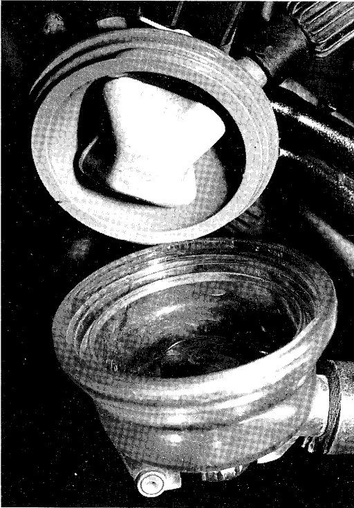
De sensoren voor het meten van de geleidbaarheid per kwartier zijn ingebouwd in de melkklaauw
