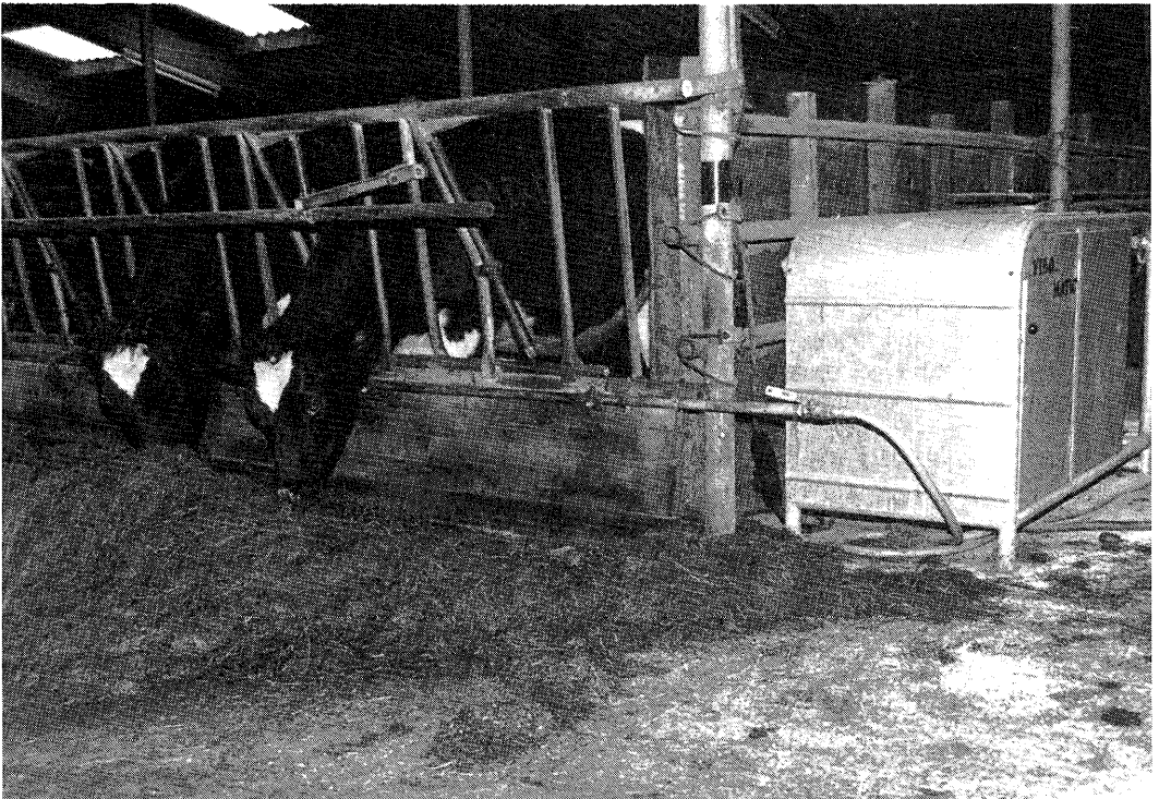
Vorraadvat, pomp en buis met sproeidoppen maken het simpel om smaakstof over het ruwvoer te sproeien.
