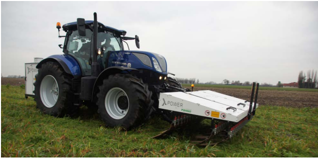
Voor de combinatie is een trekker van rond de 132 kW (180 pk) nodig.
