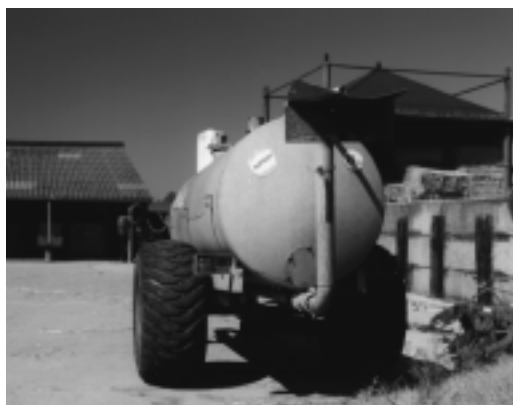
De aangezuurde mest werd met een speciale spreidplaat bovengronds toegediend.
