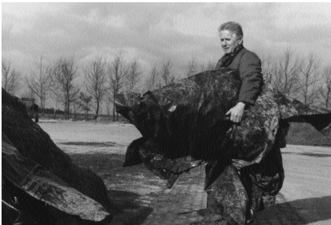
Kuilvoerfolie is vaak verontreinigd met grond en kuilvoerresten en is daardoor moeilijk te gebruiken als grondstof voor nieuw plastic.
