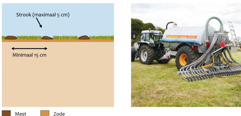
Figuur 2.5.4 Sleepvoetbemester, mest wordt tussen het gras gedeponeerd (foto: Schuitemaker Machines bv).
